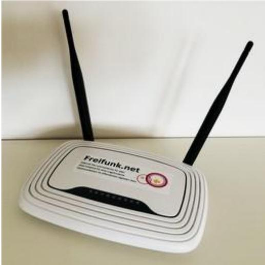
Der Freifunk-Router verbindet sich automatisch mit Freifunk-Netzwerken in der Nähe. So wird das Netz mit jedem Router etwas größer. Ein Router auf der richtigen Fensterbank sorgt so auch dafür, das Signal innerhalb der eigenen Wohnung zu verstärken.
